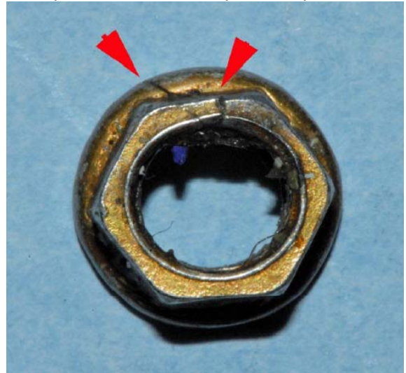
La figure 2 illustre un écrou fissuré typique trouvé.
